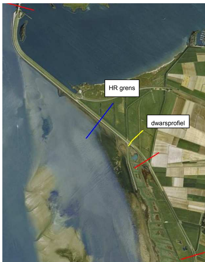
Figuur 2-2 Voorbeelden van verschil in dwarsprofiel en andere hydraulische randvoorwaarden
